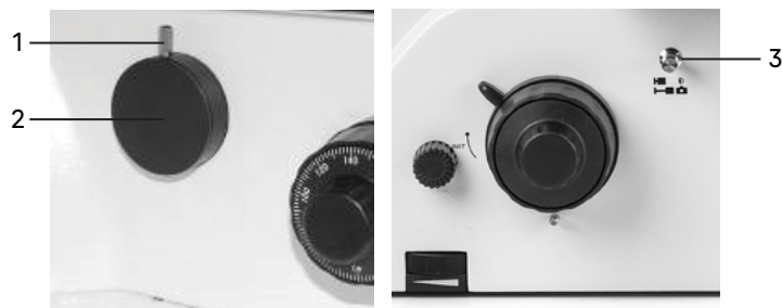
Рис. 17. Использование бокового канала визуализации
