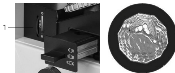
Рис. 25. Регулировка полевой диафрагмы
