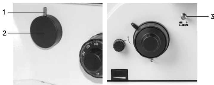
Рис. 19. Использование бокового канала визуализации
