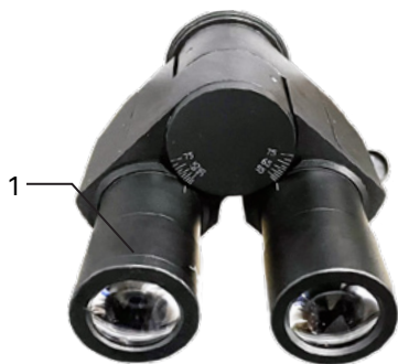
Рис. 10. Регулировка диоптрийной системы
