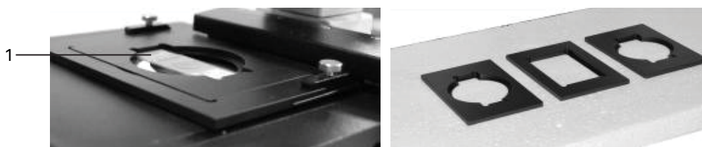
Рис. 12. Выбор и установка держателя чашки
