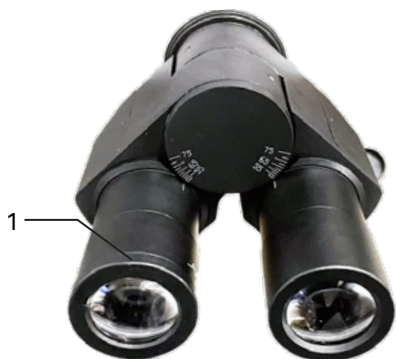
Рис. 9. Регулировка диоптрийной системы
