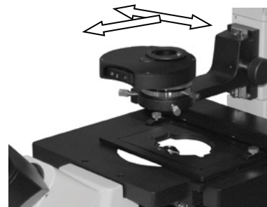
Рис. 3б. Установка конденсорного устройства
