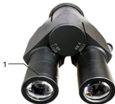
Рис. 9. Регулировка диоптрийной системы
