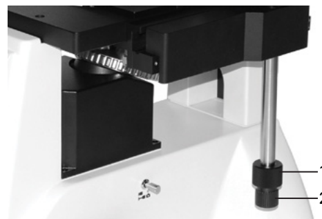
Рис. 12. Перемещение предметного столика
