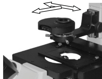
Рис. 3б. Установка конденсорного устройства
