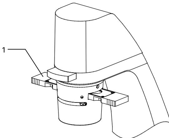
Рис. 5. Регулировка конденсора
