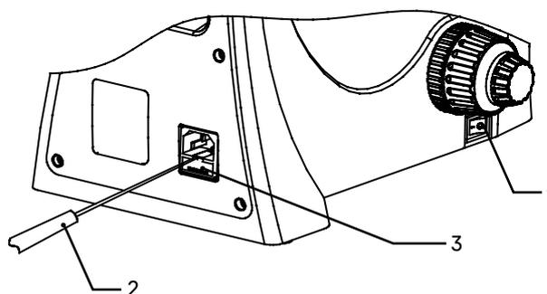
Рис. 17. Замена предохранителя
